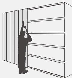
Colocar las demás tablas a mano, con un martillo de caucho o listón de madera. NO golpee la pestaña de tinglado directamente con el martillo.
