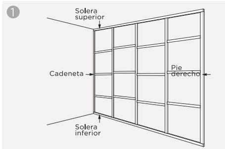
Fabricar sobre el muro un bastidor de madera con listones de pino de 2" x 1". Pies Derechos cada 40 cm. Cadenetas cada 60 cm. (\*)
