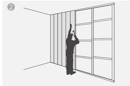
Se recomienda utilizar tornillos cabeza plana de 3,5 mm, o adhesivo de montaje en zonas de contacto.
