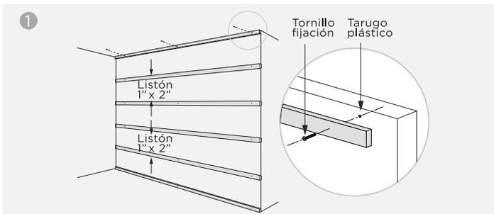
Instalar listones de madera de 1" x 2" en forma horizontal sobre el muro. Estos listones se pueden atornillar y servirán para clavar el tableado. Recomendamos instalar los listones cada 40 cm.
