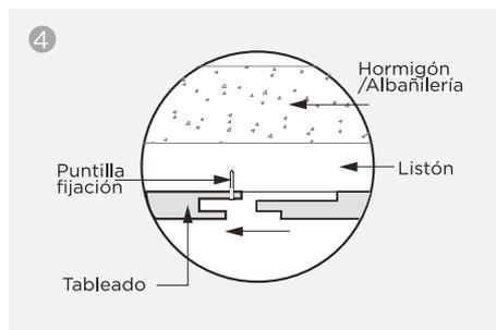
Clavar la pestaña del lado derecho de los listones horizontales. los clavos quedan ocultos al colocar la siguiente pieza.
