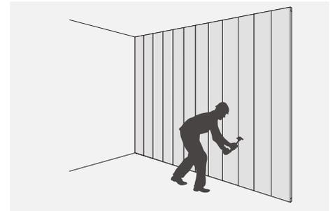
Colocar las demás tablas a mano, con un martillo de caucho o liston de madera. NO golpee el lado macho directamente con el martillo.
