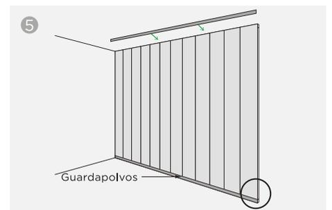
Se recomienda aplicar Molduras Masisa para los encuentros entre cielo y piso, instaladas mediante puntillas y un adhesivo de contacto para asegurar una mejor fijación.
