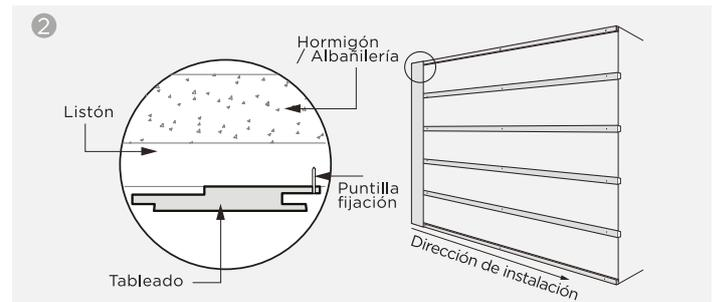
Colocar las tablas de izquierda a derecha. Poner la primera pieza perfectamente aplomada, y clavar la pestaña, o utilizar adhesivo de montaje en zonas de contacto.
