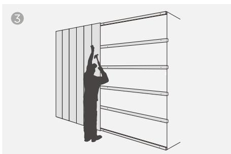
Colocar las demás tablas a mano, con un martillo de caucho o liston de madera. NO golpee el lado macho directamente con el martillo.
