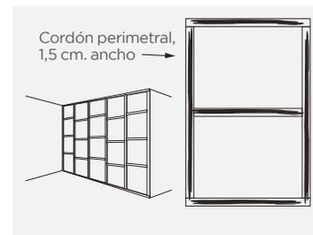
Para bastidores de madera o metálicos tipo metalcom. Agregar cordón de adhesivo en zonas de contacto.
