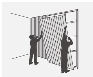
2.A Instalación directa sobre tabiquería. El revestimiento puede ser instalado directamente sobre la estructura del tabique. Fijación con tornillos para tabiquería de acero y puntas para tabiques de madera.
