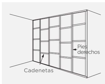
Fabricar sobre el muro un bastidor de madera con listones de pino de 2" x 1".
