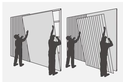
2.B Instalación previa de forro. Para lograr una mayor aislación térmica, se puede optar por montar previamente un forro de **Masisa Ecoplac**, fijado al tabique con tornillos cabeza plana de 3,5 mm. o puntillas. Luego, instalar el revestimiento con puntas, clavando sobre las ranuras para disimular.
