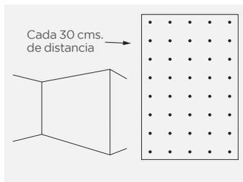
Para superficies lisas regulares o semi regulares, tipo volcanita, tablero Ecoplac, MDF o muros de albañilería. Aplicar puntos de adhesivo cada 30 cm de distancia.
