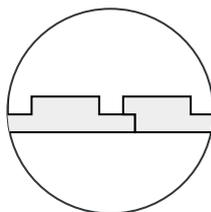
El ensamble de los paneles genera una cantería de 3 mm para las opciones A/B y de 6 mm para opción C.
