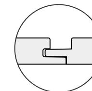
El ensamble de los paneles genera una cantería de 3 mm de ancho.
