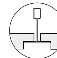
El ensamble de los paneles genera una cantería de 26 mm de ancho.
