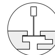
El ensamble de los paneles genera una cantería de 6 mm de ancho.
