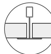
El ensamble de los paneles genera una separación visual de 24 mm de ancho.
